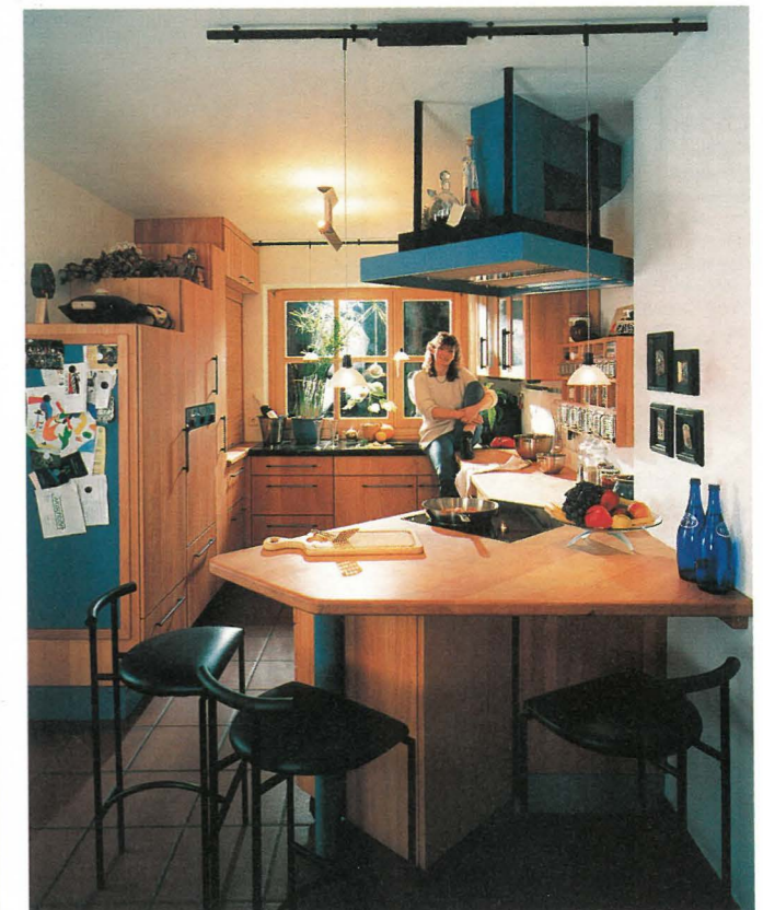
Mit dem Schienensystem werden Fenster- und Tresenbereich beleuchtet. Die indirekte Leuchte in der Mitte strahlt an die Decke (Allgemeinlicht). Die kleinen Aufbauleuchten unter den Oberschränken erhellen die Nische.
